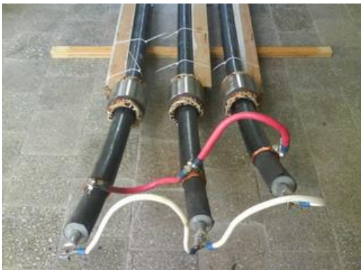
Рисунок 4 – Макет трифазної КЛ, кабелі якої охоплені ФО
