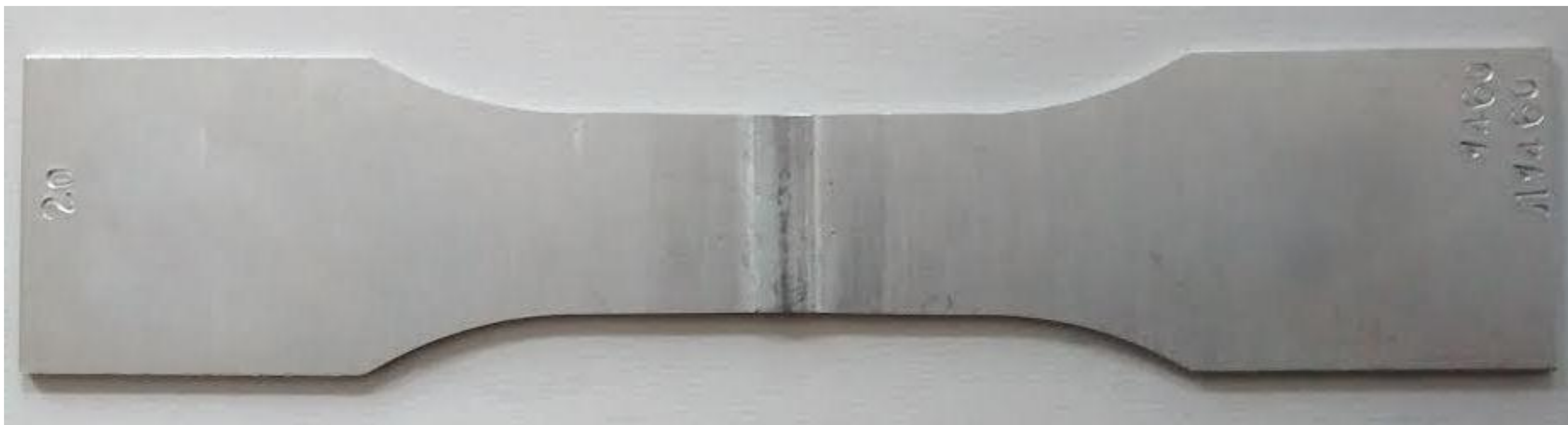
Зразок для випробувань стикового зварного з'єднання алюмінієвого сплаву 1460Т1, виконаного дуговим зварюванням неплавким електродом в середовищі аргону, товщиною 1,8 мм
