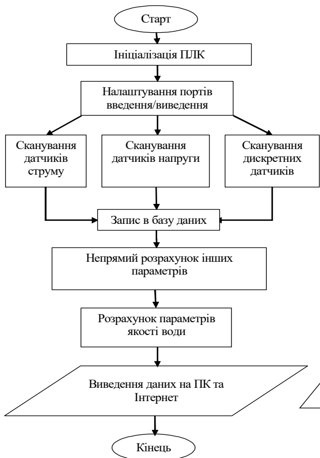
Алгоритм роботи локальної частини SCADA системи операторського моніторингу параметрів води
