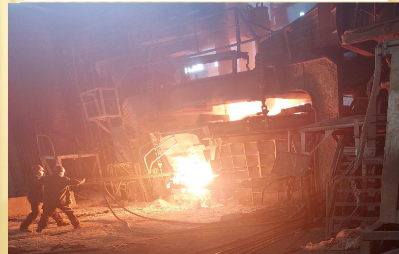
Фрагмент роботи печі ДСВ-50 з ґнотовими електродами Ø508 мм
