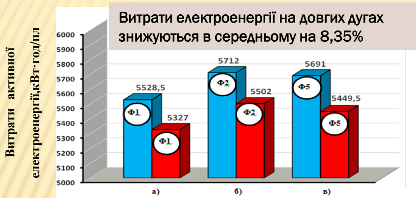
Питома витрата активної електроенергії (кВт·год/пл) на плавках 70 % FeSiMn з ґнотовими електродами на короткій та довгій дузі, де: а - серійна (синя) та довга (червона) дуга (електрод Ф1); б - коротка та довга дуга (електрод Ф2); в - коротка та довга дуга (ґніт Ф5).
