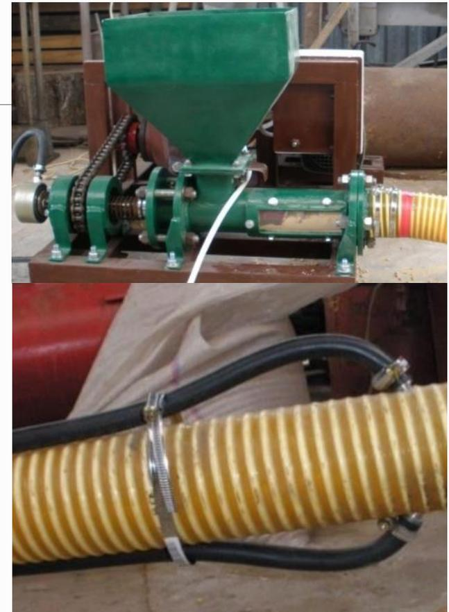
1 і 2 – опори; 3 – привід; 4 - корпус транспортера; 5 – бункер; 6 - гвинтовий живильник; 7 – пневмосистема; 8 - пневматичний клапан; 9 – секції; 10 - еластичний кожух; 11 – втулка; 12 - кільце; 13 – болт; 14 – отвори; 15 – П-подібна втулка; 16 – штуцер; 17 – шланги подачі повітря; 18 – вхідні штуцери; 19 - хомут
