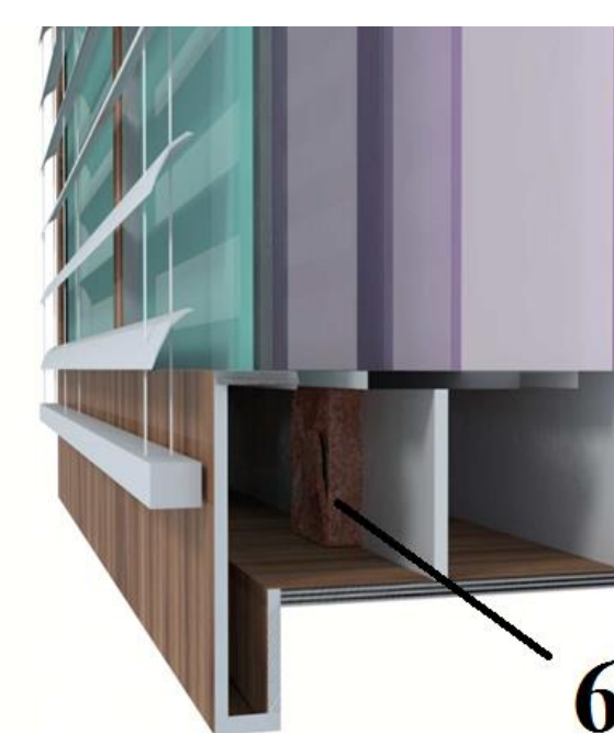
Рис. 4 – Геліовікно з гребінкою (а), теплообмінником (б) та вентилятором (в): 1 – гребінка; 2 – світлопрозоре огороження; 3 – теплообмінник; 4 – жалюзі; 5 – корпус; 6 – вентилятор
