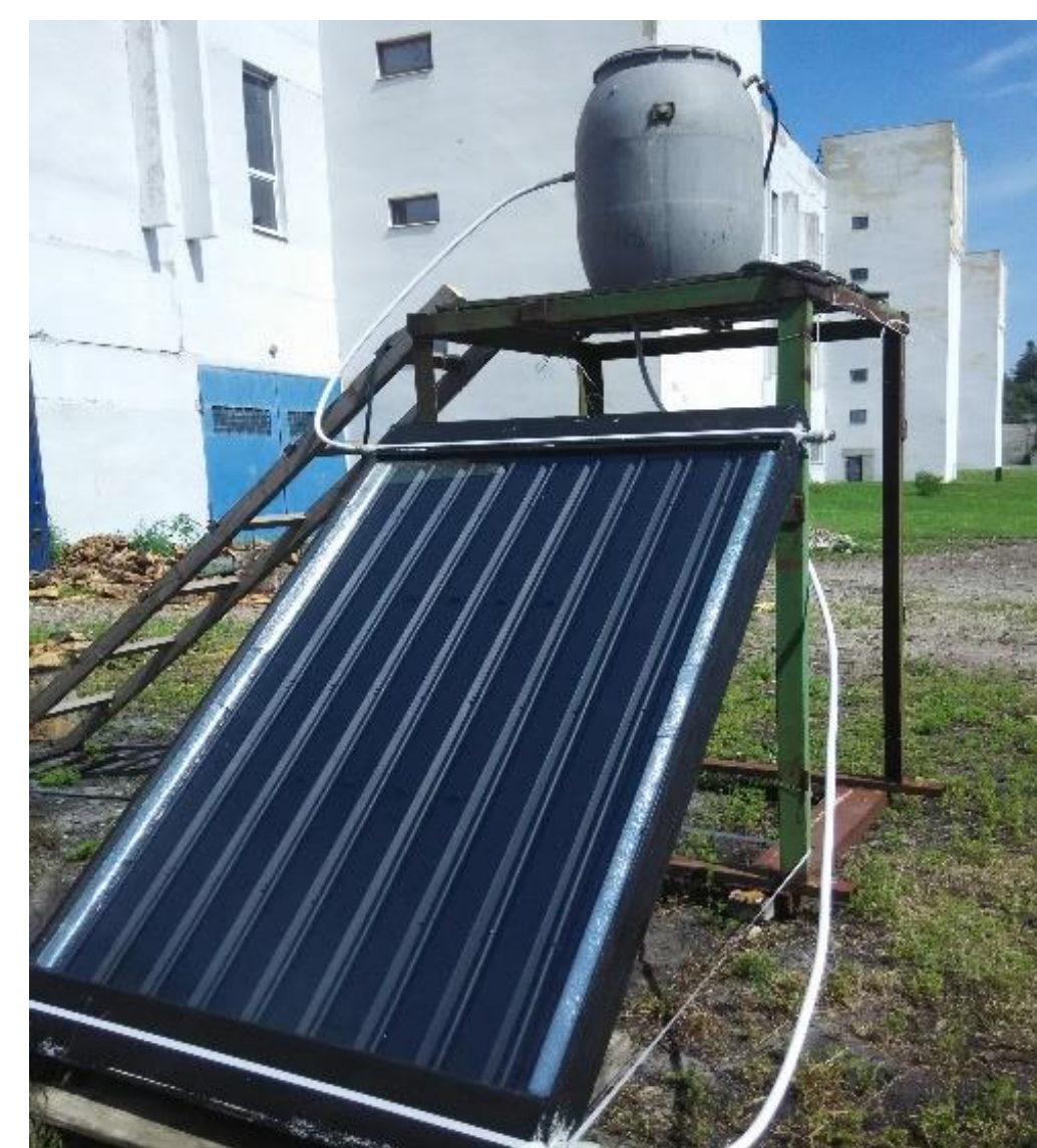
Рис.2 Натурні випробування геліюпокриття на ПП «Гізконтакт» у м.Харкові
