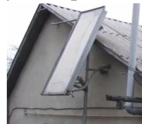
Рис.2 Натурні випробування геліюпокриття на ПП «Гізконтакт» у м.Харкові
