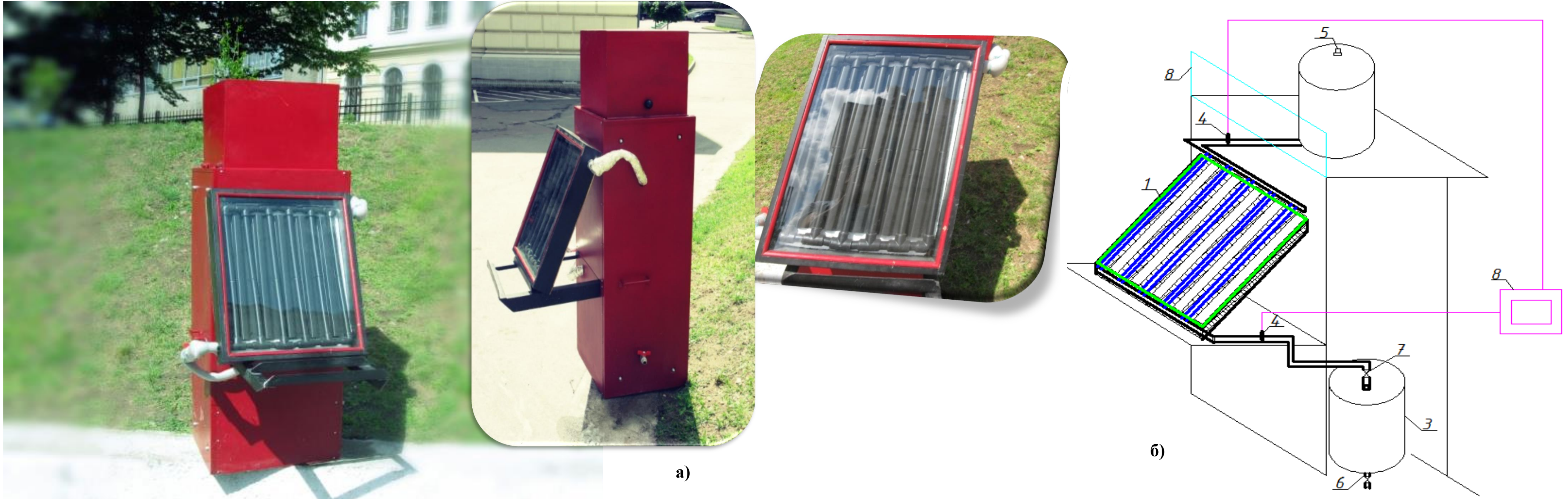
Рис. 1 Фото (а) та схема (б) експериментальної установки для досліджень геліопокрівлі в режимі потоку: 1 – геліопокрівля; 2 – ємність з холодною водою; 3 – бак-акумулятор; 4 – термометри; 5 – патрубок подачі холодної води; 6 – патрубок відбору теплоносія; 7 – запірний вентиль.
