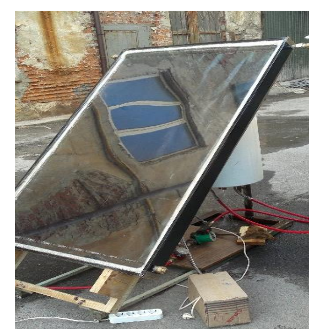
Рис.4 Натурні випробування геліюпокриття у м. Львові
