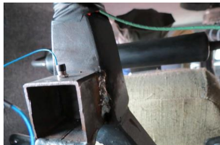
Акселерометр сидіння в районі грудей манекену
