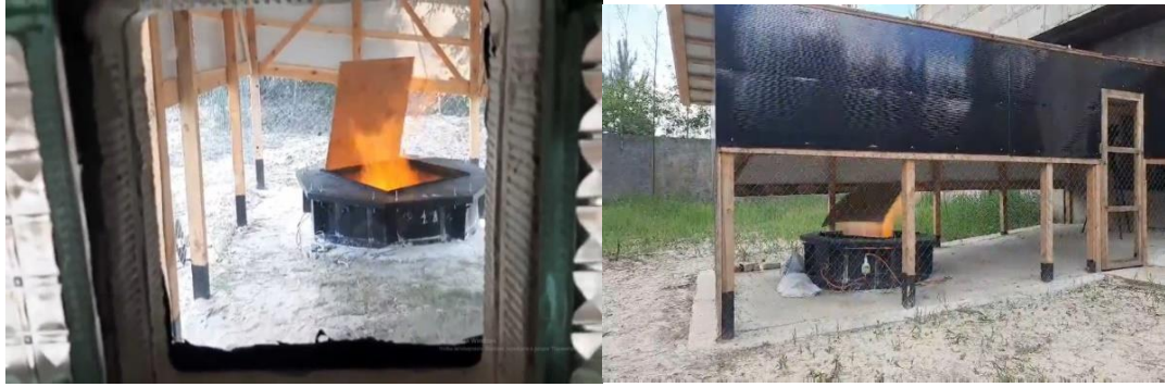
Експериментальна установка для випробувань легкоскридних конструкцій на надлишковий тиск вибуху
