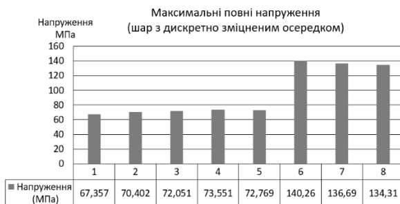
Рисунок 8 – Максимальні еквівалентні напруження (шар з дискретно зміцненим осередком) (МПа), 4-та розрахункова група
