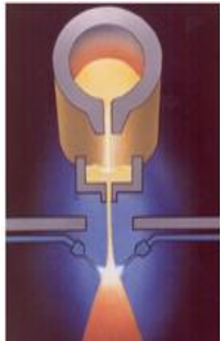
Проходження розплаву металу скрізь інертний газ, технологія VIGA
