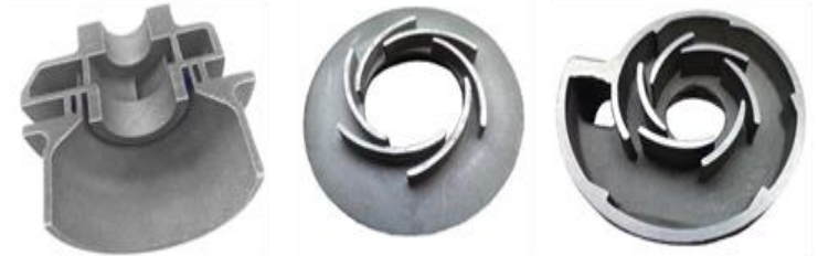
Завихрювач розрізаний за перерізами креслення
