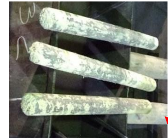
Кування виконували по схемі "квадрат-круг" з \varnothing 106 на \varnothing 59 мм
