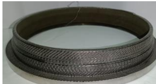
Зовнішній вигляд заготовки деталі «Кільце» після вирощування методом МПН
