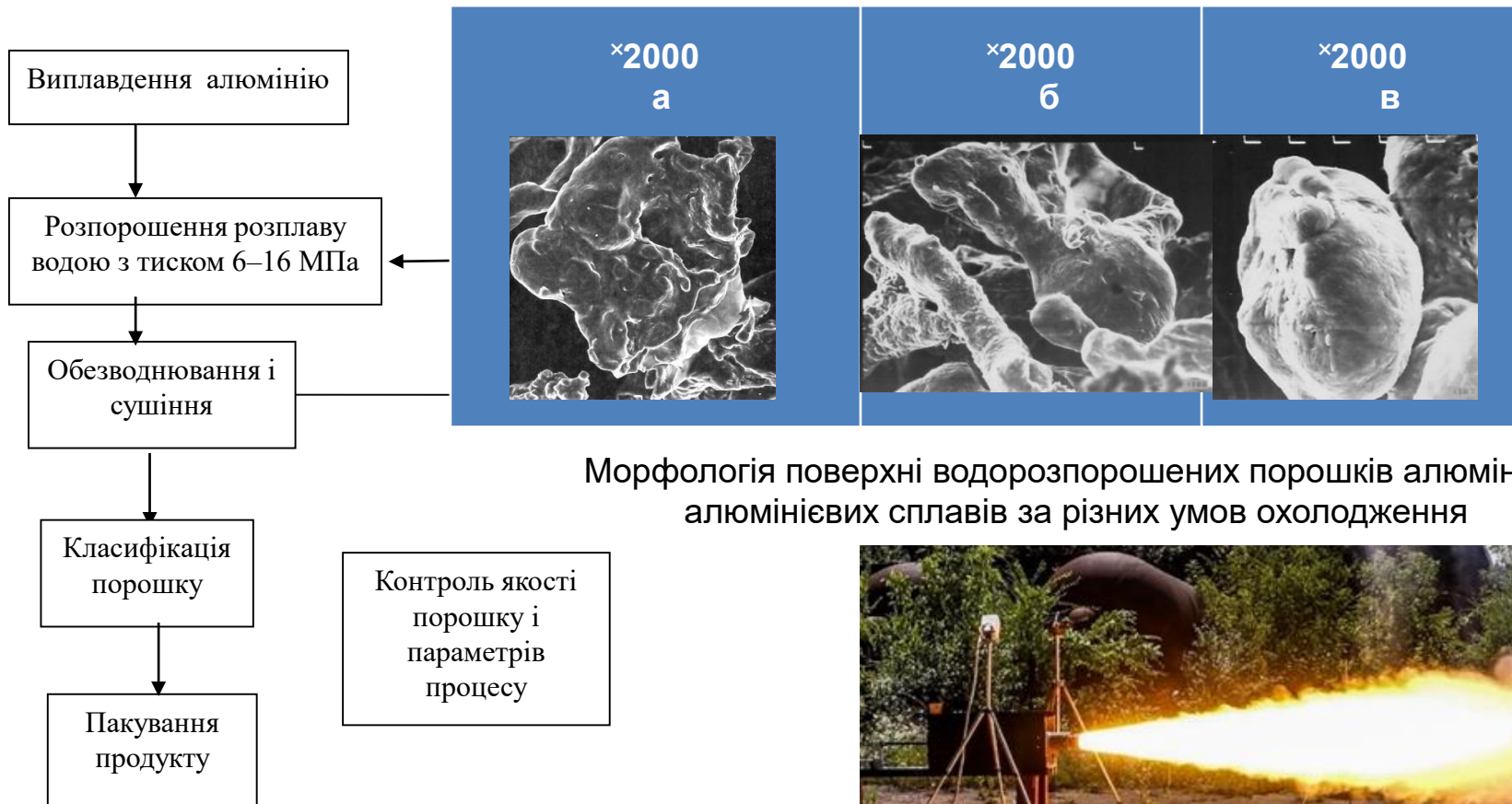
Схема технологічних процесів виготовлення дисперсного порошку алюмінію
