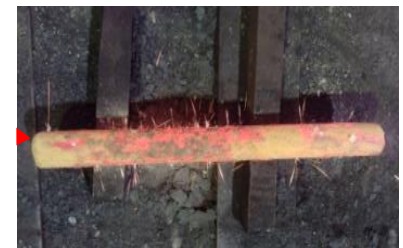
Кування виконували по схемі "квадрат-круг" з \varnothing 106 на \varnothing 59 мм
