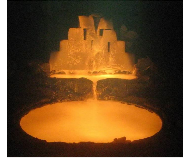
Процес електронно-променевої плавки зливка: а - Ø400мм BT22; б - Ø600мм BT14
