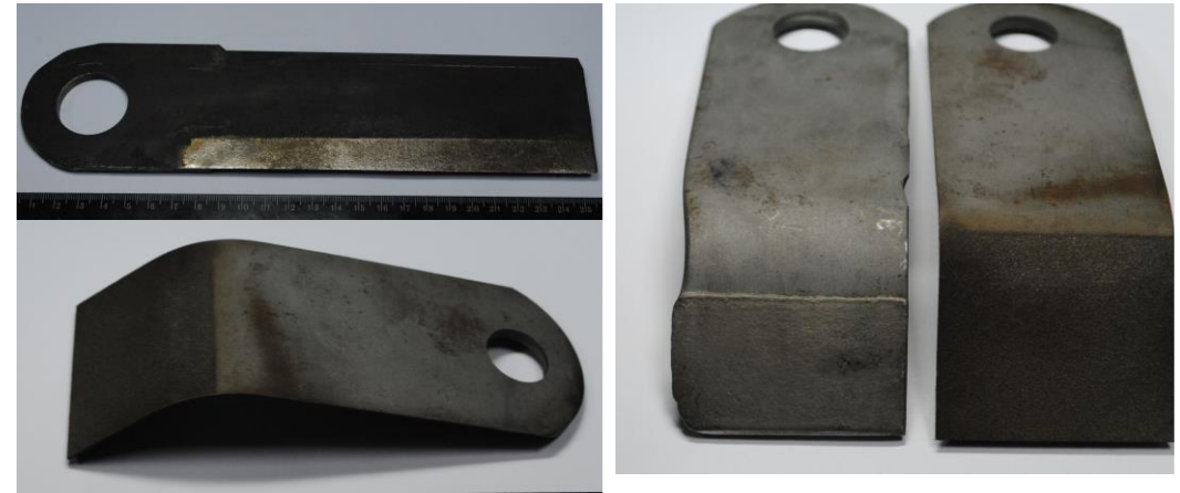
Газо-полум'яні покриття із сплаву НВ-4 на робочих деталях різного ріжучого інвентаря (а). Як приклад наведена в т.ч. зношена непридатна деталь з наплавленим захисним шаром (б - зліва).
