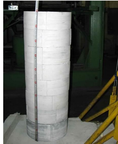
Жарова труба із ультра-високотемпературної кераміки для пальника спалювання вугілля на електростанціях.
