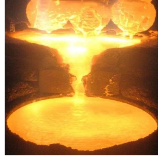
Процес електронно-променевої плавки зливка: а - Ø400мм BT22; б - Ø600мм BT14
