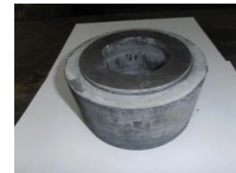
Жарова труба із ультра-високотемпературної кераміки для пальника спалювання вугілля на електростанціях.
