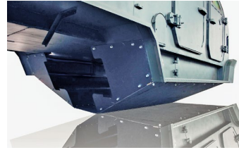
Рисунок 9 – Протимінний захист бронев автомобілів компанії «ПРАКТИКА»
