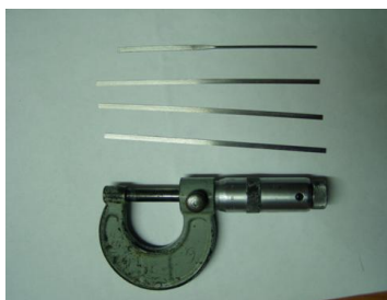
Рис. 9 – Зразки вольфрамових стрічок, що отримані при прокатці дроту
