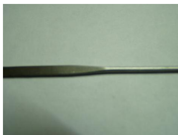
Рис. 9 – Зразки вольфрамових стрічок, що отримані при прокатці дроту
