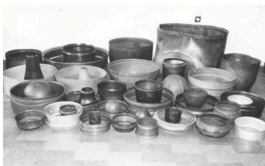
Рис. 11 – Загальний вигляд деталей, отриманих штампуванням вибухом зі зварених циліндричних заготовок
