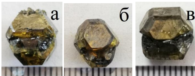
Рис. 4. Монокристали алмаза типу Ib «бінарного» типу: а – тривалість циклу вирощування t=189 год, маса m=6,93 каратів, температура вирощування T=1453-1389 °С; б – t=178 год, m=5,72 каратів, T=1445-1392 °С; в – t=192 год, m=8,07 каратів, T=1441-1378 °С.
