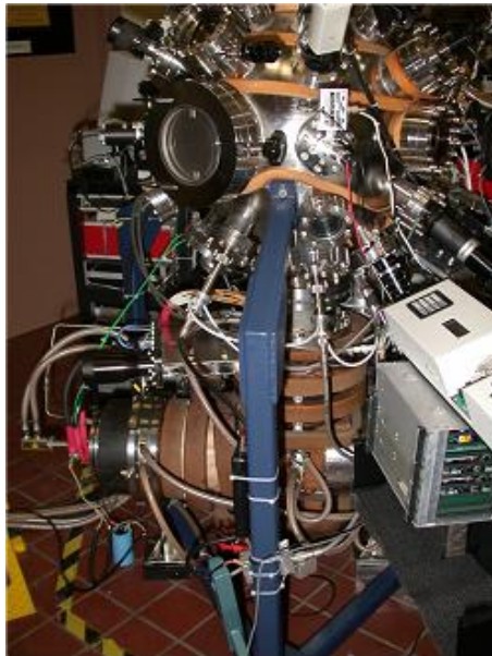
Рисунок 1. Широкоапертурне джерело фільтрованої вакуумно-дугової плазми
