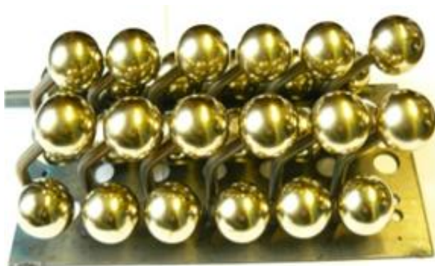
Головки з титану VT1-0 для ендопротезів кульшового суглоба людини
