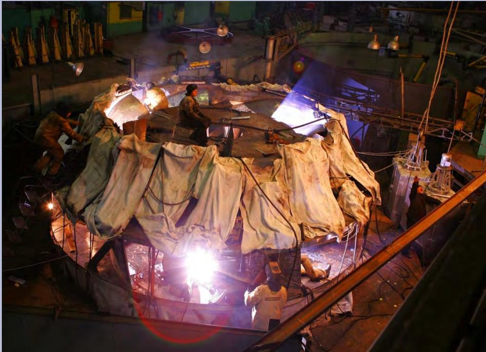
***Зварювання робочого колеса гідромашини***
