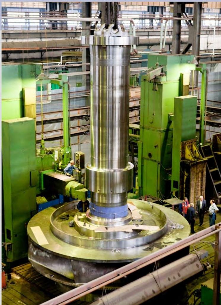
*Спарювання робочого колеса з валом*
