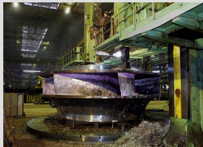
*Оброблення робочого колеса масою 113,5 тонн*
