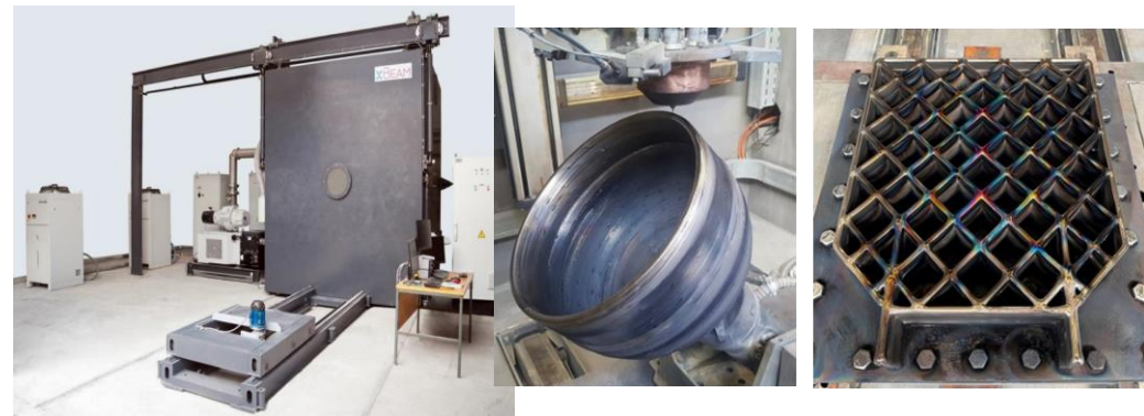
Обладнання для 3д друку та отримані титанові вироби
