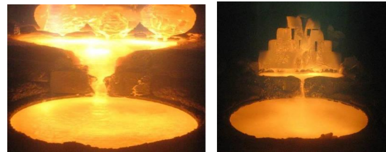
Процес електронно-променевої плавки зливка: праворуч - Ø400мм VT22; ліворуч - Ø600мм VT14
