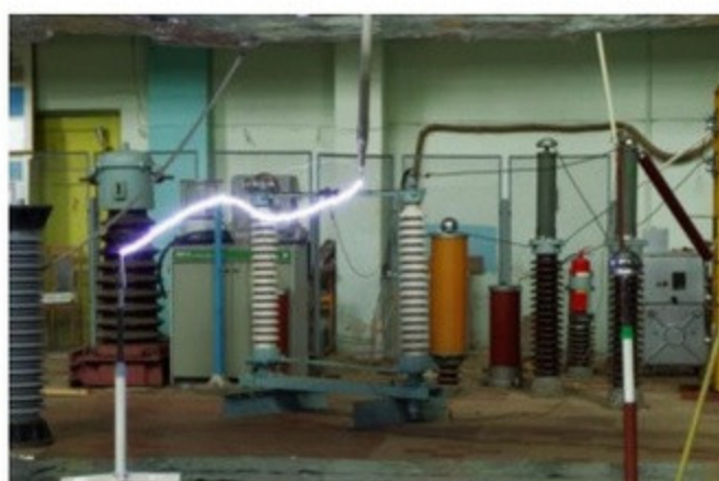
Рис. 9. Експериментальні дослідження в високовольтному залі НТУ «ХПІ» процесів, що імітують удари блискавки.
