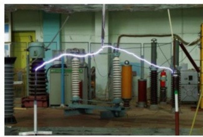
Рис. 9. Експериментальні дослідження в високовольтному залі НТУ «ХПІ» процесів, що імітують удари блискавки.
