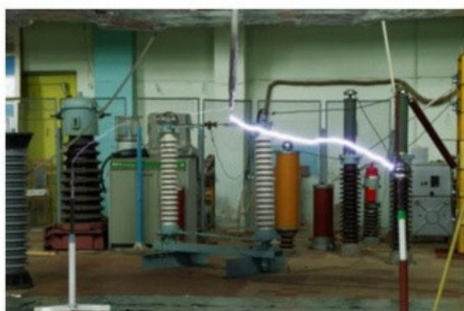
Рис. 9. Експериментальні дослідження в високовольтному залі НТУ «ХПІ» процесів, що імітують удари блискавки.
