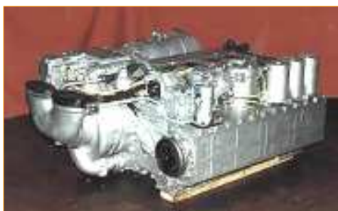
Рис.7. Форсовані двигуни 5ТДФ для модернізації бойових машин "Булат"
