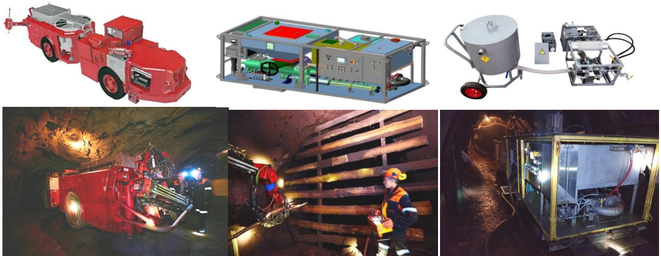
Рис. 9 Змішувально-зарядна техніка для механізованого заряджання віяла свердловин ЕВР Україніт-ПП-2 (зліва направо): самохідні RTSh-23 та ПЗМК-500 (зарядний модуль); мобільна установка УБМ-1 (для заряджання на відкотних горизонтах).
