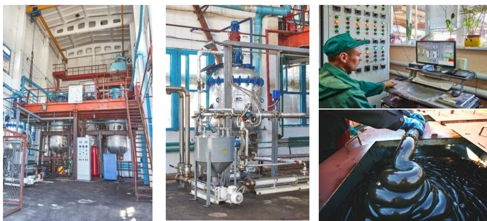
Рис. 13 Виробництво шахтної наливної емульсійної композиції ЕК на підприємствах: - комплекс «Інгулецький» (КФ ТОВ «УВТ») - ПрАТ «Промвибух»
