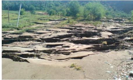
Рис. 1 Провальні зони земної поверхні (шахта «Тернівська» ПАТ КЗРК, шахта ім. Орджонікідзе ПрАТ ЦГЗК, 2010р.)
