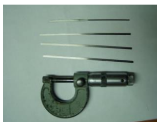
Рис. 8 – Зразки вольфрамових стрічок, що отримані при прокатці дроту
